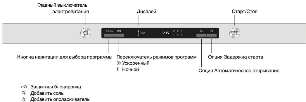
Установите посудомоечную машину, смотрите раздел Установка. Затем откройте дверь и нажмите главный выключатель электропитания, чтобы начать использовать машину.
